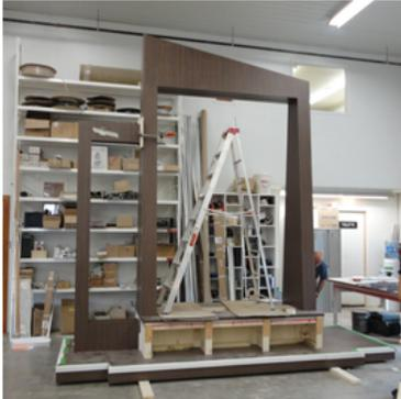
Installation - Vérification du mur d'eau
